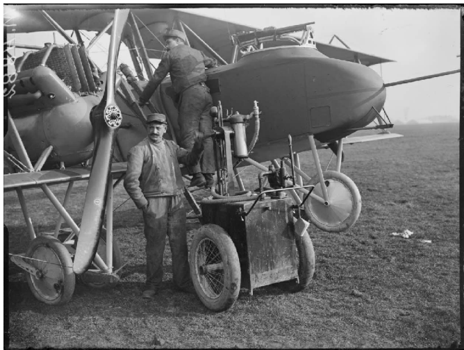
26 / Référence : SPA 257 M 4882 Villacoublay, camp d'aviation. Machine à pomper l'essence dans le réservoir d'un avion Letord. 20/02/1918, opérateur Albert Moreau.
