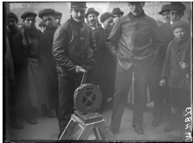
25 / Référence : SPA 257 M 4873 Paris, essais d'appareils avertisseurs en cas de raids d'avions ennemis (sirène à manivelle). 19/02/1918, opérateur Albert Moreau.
